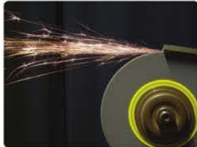
شكل (١٧): لماذا تنطلق شظايا المعدن المتوهجة باتجاهات مستقيمة وبسرعات مماسية عند استعمال حجر المسن الكهربائي؟
